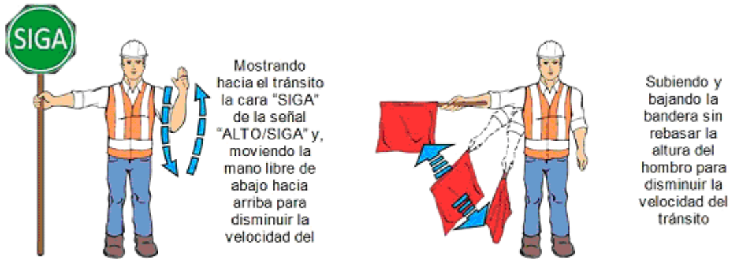
FIGURA 6.- Para alertar y disminuir la velocidad del tránsito
